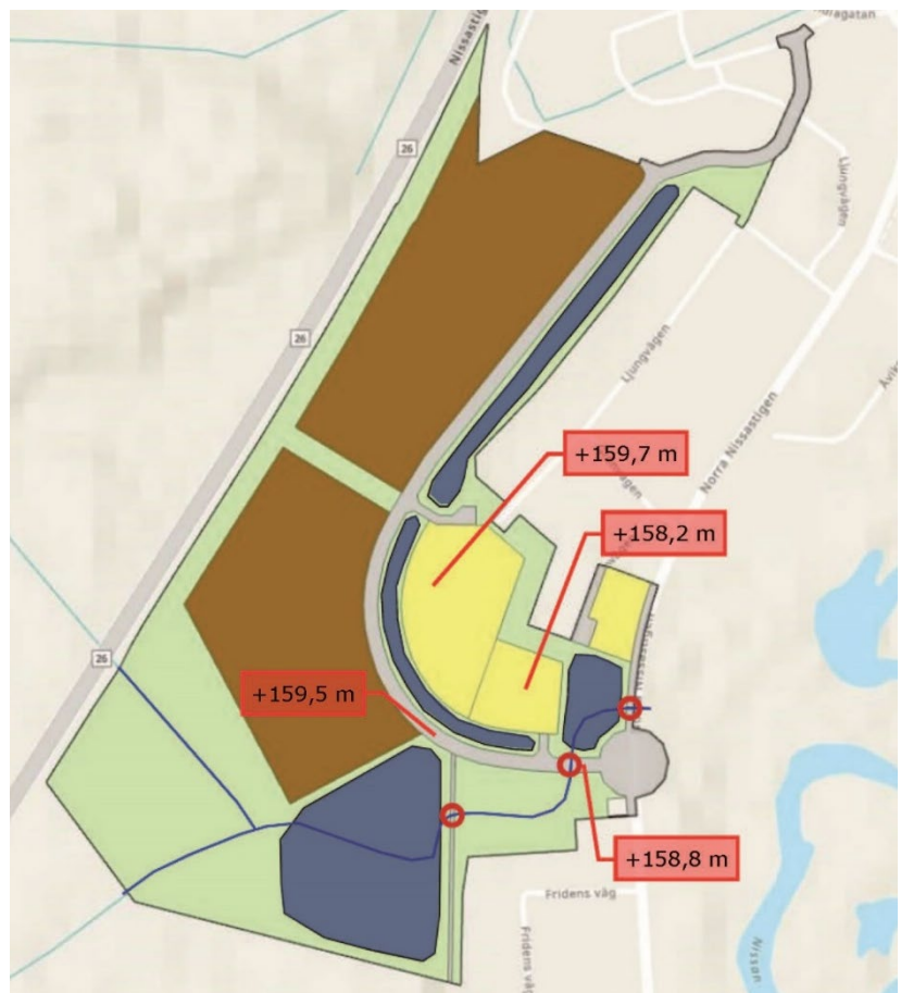
Schematisk skiss på lämpliga ytor för fördröjning av dagvatten vid skyfall (mörkblåa områden). Trummor under vägar är redovisat med röda ringar.
