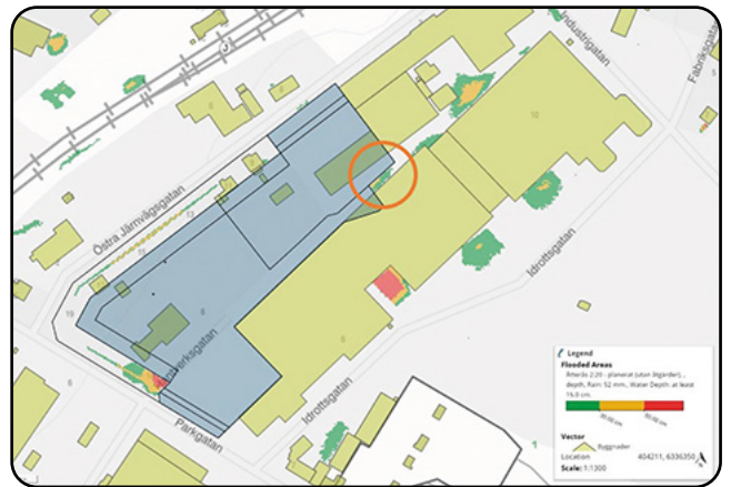
Ansamling av vatten vid skyfall. Färgskalan grönt-rött visar olika djup för stående vatten. Planerade förhållanden fig. 25
