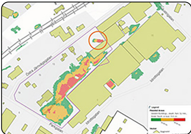
Ansamling av vatten vid skyfall. Färgskalan grönt-rött visar olika djup för stående vatten. Befintliga förhållanden fig. 23
