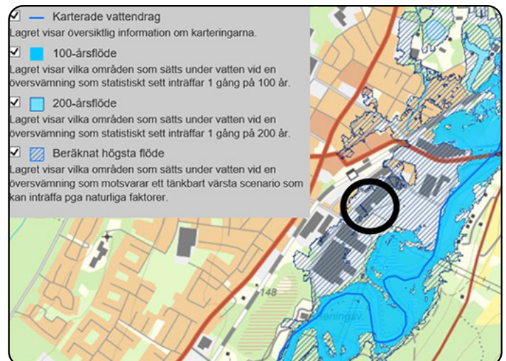
Planområdets placering visas med svart ring. Nissans utbredning vid 100- och 200-årsflöde samt beräknat högsta flödet.
