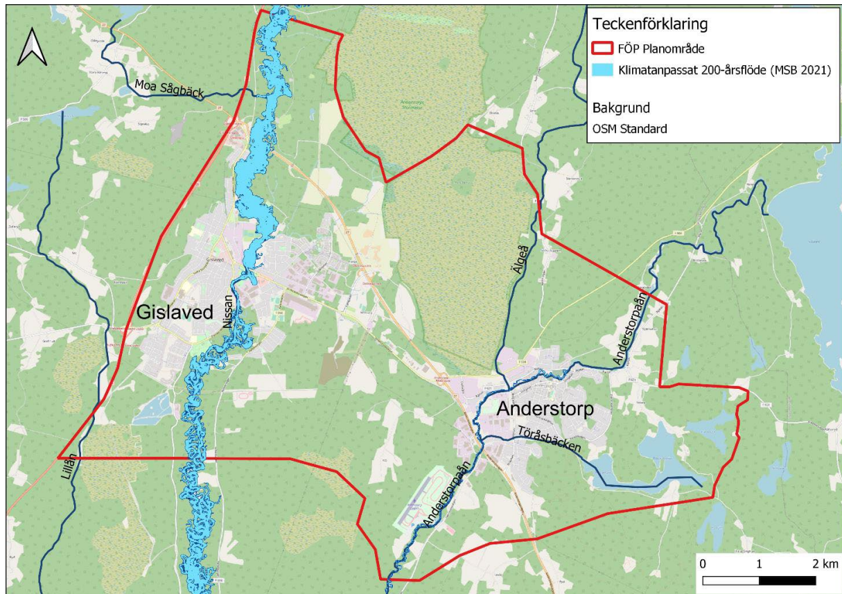
Figur 26. Klimatanpassade vattenflöden i Nissan vid ett 200-årsregn. Översvämningskartering utmed Nissan inklusive biflödet Kilan, (MSB 2021).
