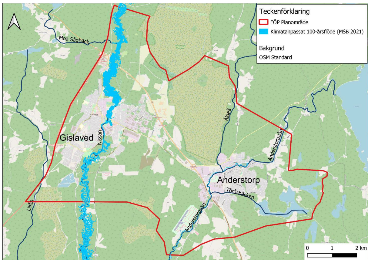
Figur 25. Klimatanpassade vattenflöden i Nissan vid ett 100- årsregn. Översvämningsskartering utmed Nissan inklusive biflödet Kilan, (MSB 2021).
