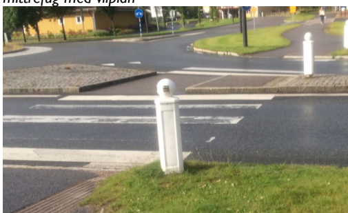
Figur 7. Övergångsställe med ramp, platta med fasad kantsten och ledstråk, pollare med taktila symboler och mittrefug med vilplan
