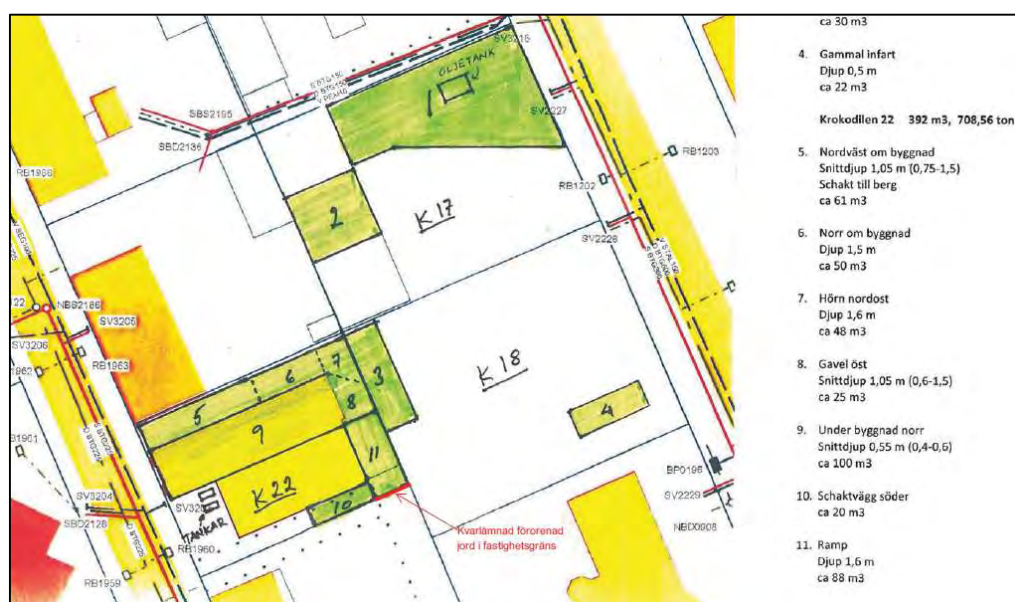
Figur 7 Figur med saneringsområden, volymer och kvarlämnad förorening, f.d. Krokodilen 17, 18, 22. (Vectura).
