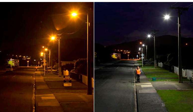
Illustration som visar skillnaden mellan natrium och LED-lampor.
