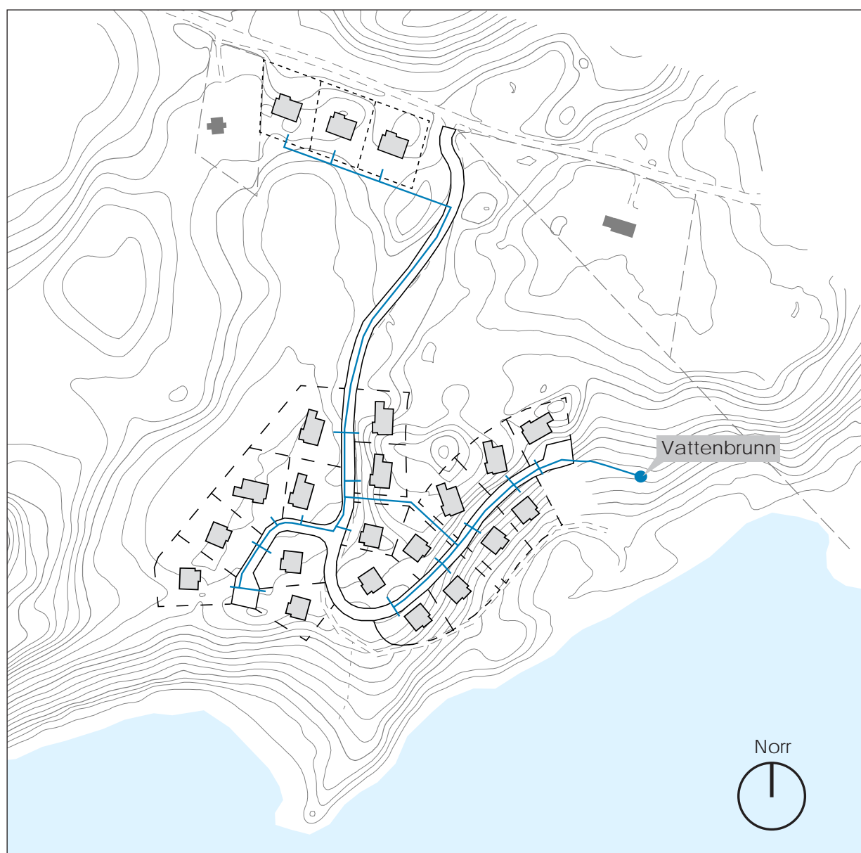
Figur 1. Exempel på dragning av vattenledningar
