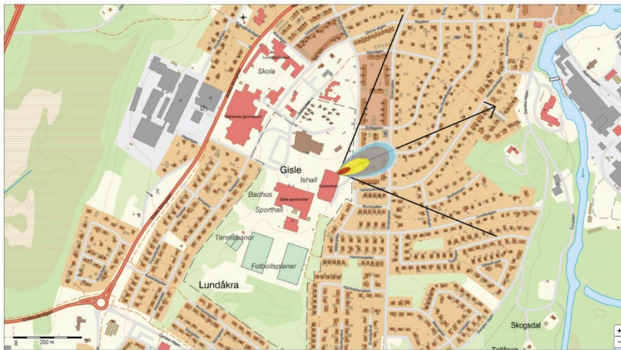
Ett av de värsta fall scenarion illustrerade vid utsläpp från ny ombyggd kylanläggning
